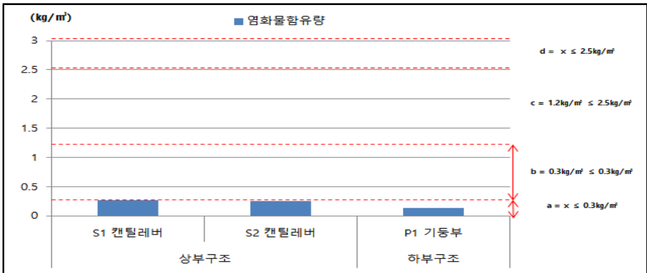
【그림 3.21】 염화물시험 측정결과
